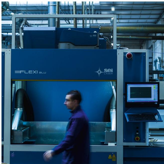
Macchina per la microincisione laser del PMMA
