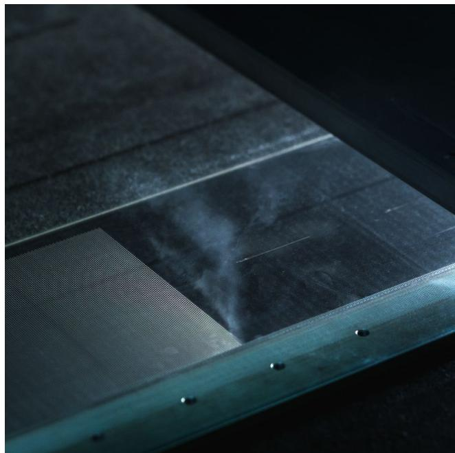
Lavorazione laser del PMMA
