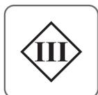
Classe III : Luminaires fonctionnant en très basse tension de sécurité (TBTS) de 50V maximum et ne nécessitant aucune protection supplémentaire.
