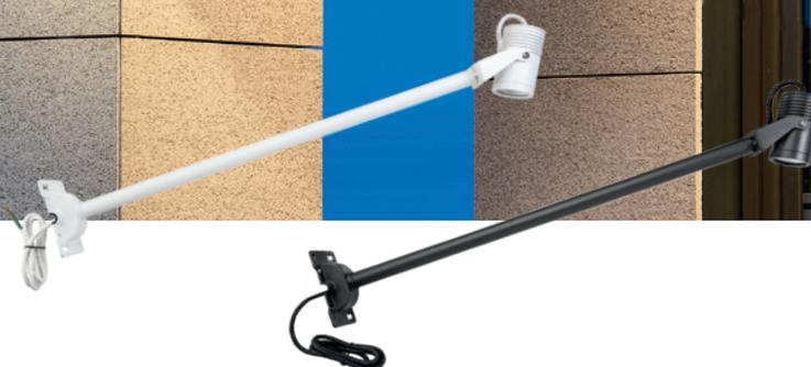
Hovden Sign est un luminaire pour enseigne avec une tête articulée inclinable suivant les besoins. Aluminium laqué, garantie 10 ans contre la corrosion. Fourni avec 1 mètre de câble H07RNF. Compatible avec un variateur à coupure de phase en aval. Certifié IP67 grâce à son module LED intégré protégé. Visière anti-éblouissement en option.
