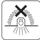
Un luminaire portant ce symbole ne doit pas être recouvert d'isolant sans la Downlightbox, Multibox, Multibox Mini, Glesbox, Ledbox 48 ou Sealbox du luminaire en question.
