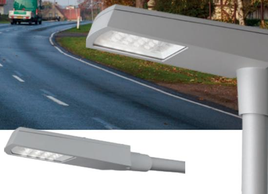
Luminaire LED pour montage en top de mât. IP66. Socle et tête en fonte d'aluminium en gris texturé, face avant en verre trempé. Solutions optiques à lentille directe (lentilles multiples). Complet avec alimentation LED pour sources lumineuses LED montées sur platine avec connexion interne et pré-câblé avec câble de raccordement (6m).
