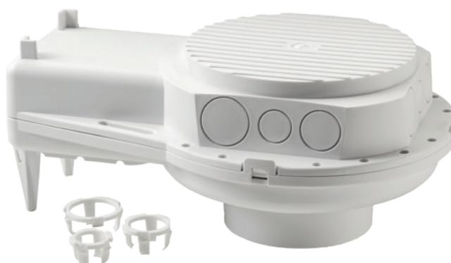
Boîtier d'encastrement-béton permet d'encastrer des downlights dans les plafonds béton. Testé et approuvé pour les downlights SG. Structure PP avec classement feu V-0. Conçu pour faciliter le travail au moment de la pose. Diamètre interne de 83 mm, prévu pour Junistar Lux, Junistar Eco, Junistar Soft et Uniled.
