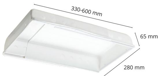
Boîtier d'encastrement plafond, longueur réglable de 33 à 60 cm, pour installation sous le pare-vapeur, par simple vissage sur chevrons. Empreintes défonçables de 16 et 20 mm, sur chaque longueur, pour passage et fixation des gaines-câbles. Fabriqué en Polypropylène (PP) blanc, résistant à la chaleur : matériau sans halogène, auto-extinguible V0 (UL94) – 850°C (IEC-695-2-1).
