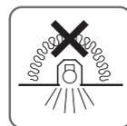
Le luminaire ne doit pas être installé en contact direct d'un matériau d'isolation, à moins d'utiliser un boîtier d'encastrement ou de protection.
